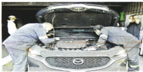
■ Las unidades eran sometidas a inspección para descartar fugas en las mangueras.
